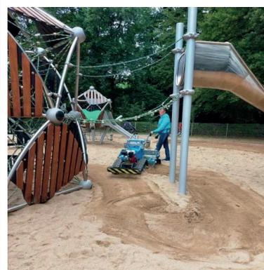
Die fiorentini-cfc Baby Tapiro ist eine mobile Sandreinigungsmaschine (auch Strandreinigungsmaschine oder Beachcleaner) zur Reinigung und Oberflächenaufbereitung von Sandstränden, Sandspielplätzen, Beachvolleyballfeldern oder Golfplätzen. Die Maschine fährt auf Gummiraupen welche jegliches einsinken im Sand verhindern, wird von einem Benzinmotor angetrieben und von einem Bediener geführt.
